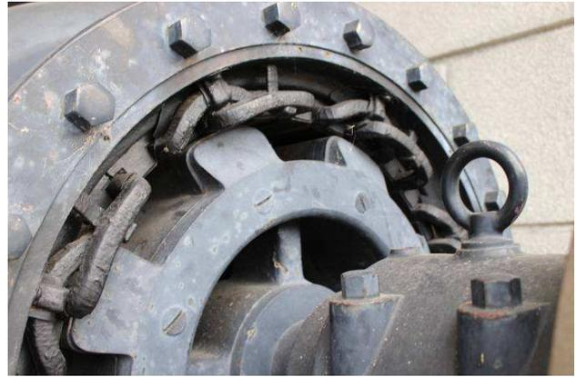
スタンレー式発電機と回転子、固定子のアップ
